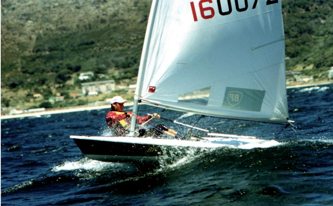
En la foto destaco el exceso de tensión del cunningham cuyo efecto permite que la parte pegada al mástil, 20 centímetros de ancho por toda la altura del mástil permanezca sin trabajar o aportar a la potencia. La superficie que trabaja se disminuye en 1 metro cuadrado aproximadamente.
