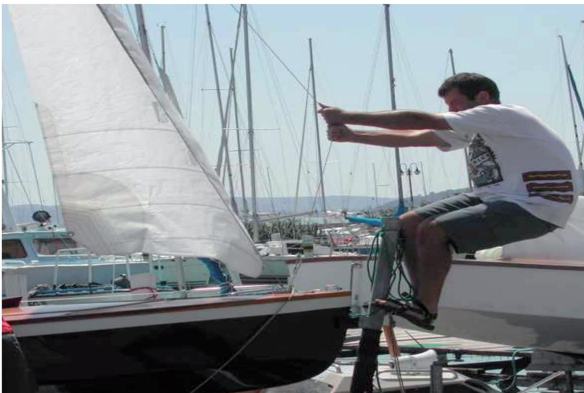
La foto muestra a un tripulante en el acto de tensar la relinga de acero de la vela para deformar el mástil y eliminar el sag en busca del ángulo de ataque del foque. Después de esto el estay queda suelto.
