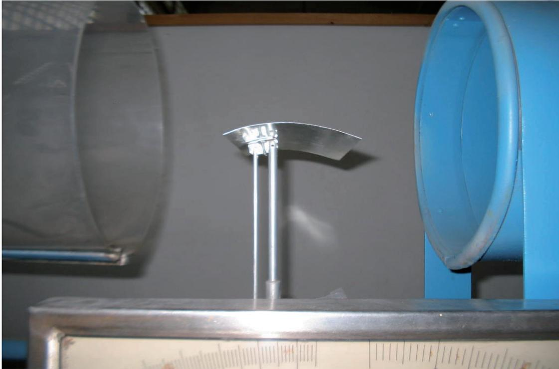
Los perfiles empleados en el túnel fueron construidos con plancha lisa de acero galvanizado rectangulares de 12x 24 cm, de 0,50 milímetros de espesor y afianzados al pilar que detecta esfuerzos horizontales o arrastre y verticales o alzamiento, que es la suma de la presión directa más la sustentación.
