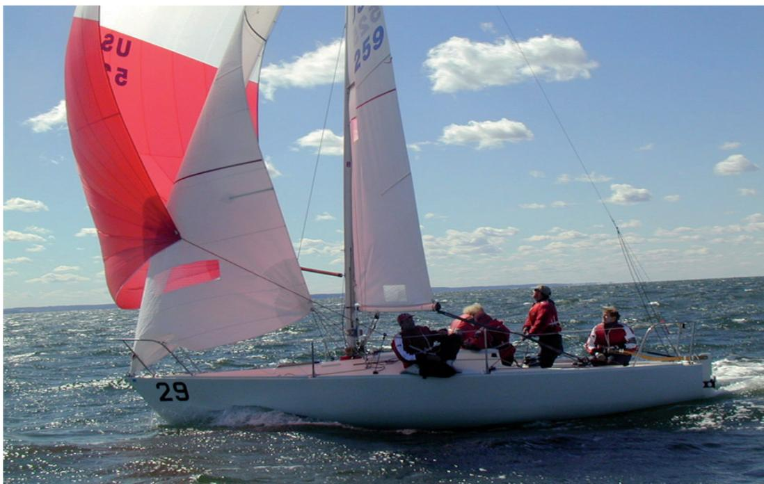
La posición del puño de escota del globo es regulado horizontalmente por la escota y verticalmente por los Pi. Si el puño se eleva da más salida al viento, el globo se aplana y genera menos freno o arrastre y menos escora. Por el contrario, si el puño baja, la baluma se cierra y provoca los efectos contrarios.
