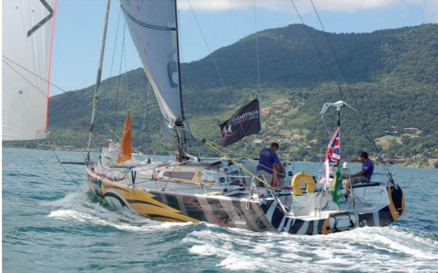
En un casco de popa plana y ancha, como el de la foto, la atención de este importante detalle es obligatorio para lograr mayores velocidades, no por mayor potencia de las velas que disminuye con la escora, sino por la disminución del arrastre que provoca la mayor superficie en contacto con el agua turbulenta. Negociar esa relación es tarea de la sensibilidad del timonel, no de un piloto automático.
