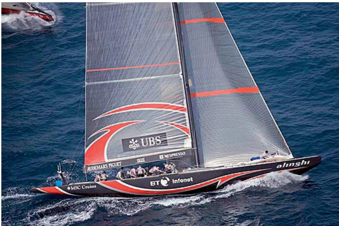
En esta foto del Alinghi se aprecia que el pujamen está completamente en contacto con la cubierta para evitar el freno inducido por la vela en la parte baja.
