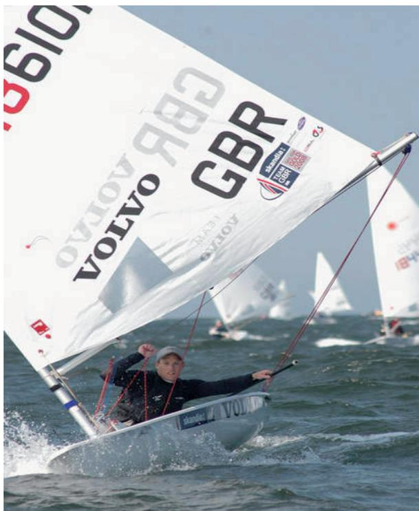
En embarcaciones menores o de más ágil respuesta a los comandos, y que navegan en este rumbo las escotas siempre van en la mano, o en la reducción, tal como puede apreciarse en la foto anterior, o en posición de ser lascadas y tesadas con facilidad para mantener la velocidad constante. Con viento fuerte el efecto disminuye, pero el riesgo aumenta.
