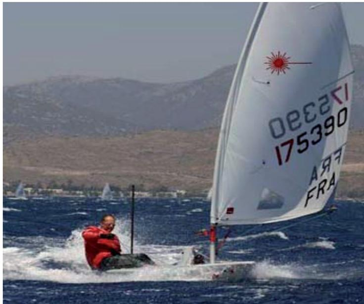
Con un mástil demasiado flexible es difícil aplicar los ajustes para lograr la forma deseada. Observe los catavientos de la vela de la foto.
