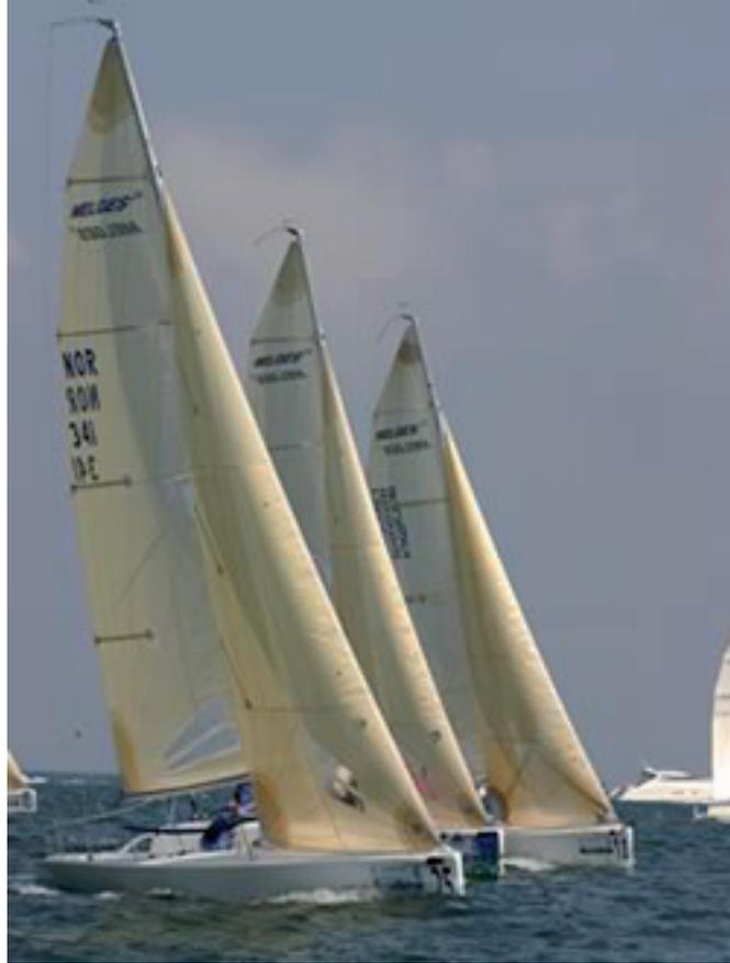
Estos botes (clase Melges?) tienen un foque muy largo y les es difícil eliminar la comba del estay. El ángulo de ataque varía con la altura. Eliminar el sag o la comba de foque o de la genoa es primordial para lograr un buen proyecto de forma y de funcionamiento de toda la superficie de la vela. Se sabe que estos botes no pueden optar a ceñidas con buen ángulo. El remedio ahora lo conocen.
