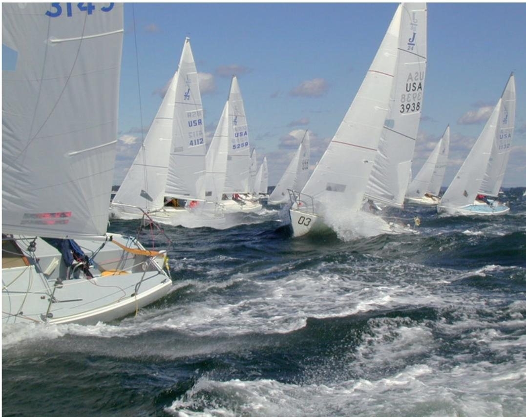
Si navegamos en aguas agitadas tendremos el inicio de la turbulencia en nuestra capa límite mucho antes que si navegamos en aguas quietas. En aguas quietas tenemos menos freno por roce. En vientos limpios tendremos menos freno en toda la arboladura que navegando detrás de toda una flota. Por eso en regatas es tan importante buscar aguas y viento limpio, especialmente en las partidas.
