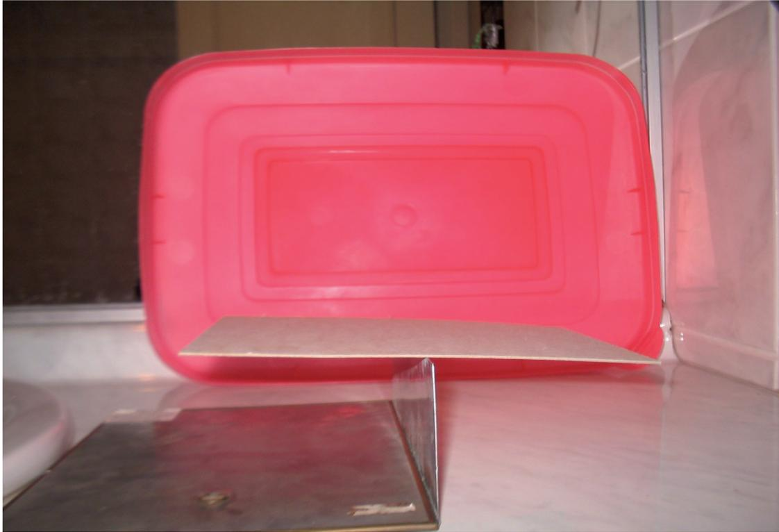
Al aplicar el chorro de aire a la placa plana, como la foto siguiente, se pudo comprobar que la placa tomó la inclinación paralela de la dirección del flujo. Si el flujo lo cambiábamos de ángulo, como se muestra en la segunda foto, la placa se movió hasta tomar nuevamente la posición paralela al flujo.
